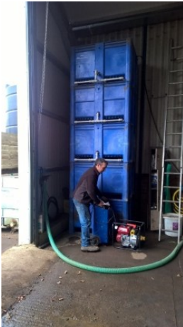
Billede 1. Hjemmelavet rensningsanlæg til kemi: Søjle af jord, halm, kompost og muld. Indhold i top= 4000 mg kemi/l, indhold i bund: 10-15 mg/l.
